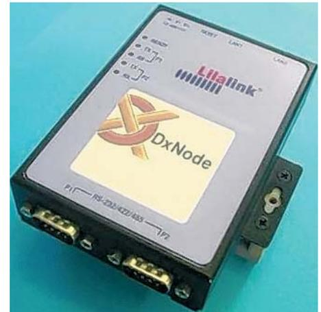
Auch «Embedded» ist der DxNode bereits in Verwendung. Zur Feldebene stellt diese «Linux Box» verschiedene Standardprotokolle zur Verfügung. Der Knoten ist in der Linux-Umgebung eingebunden und kann über die switchfähigen RJ 45-Anschlüsse verwaltet werden
